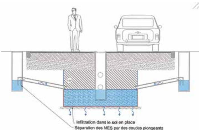
Coupe de principe des ouvrages hydrauliques en infiltration
