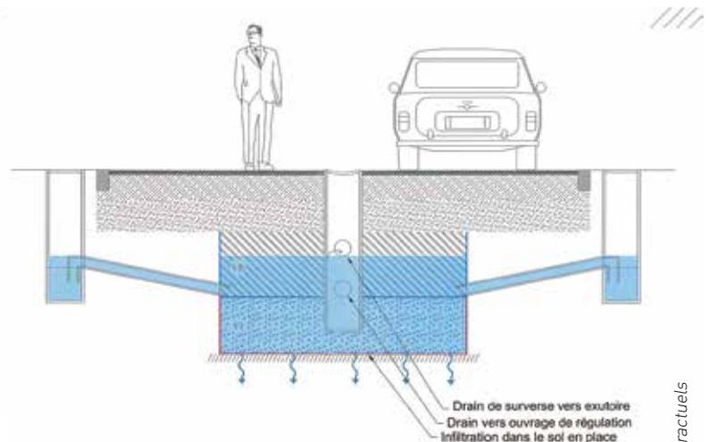
Coupe de principe des ouvrages hydrauliques en infiltration + régulation
